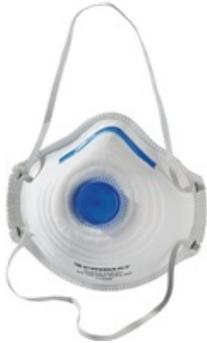
mit Cool-Down-Ausatemventil · gegen mindergiftigen und gesundheitsgefährdenden Staub, feste und wässrige Partikel und Aerosole bis zum 10-fachen des Grenzwertes · Filterklasse: **DIN EN 149:2001 FFP2 NR** · vorgeformter und schaumstoffgefüllter Nasenbereich mit flexiblem Nasenbügel · bequemer und hautsympathischer Dichtsitz · das Ventil erleichtert das Ausatmen und verhindert einen Hitzestau in der Maske ·
