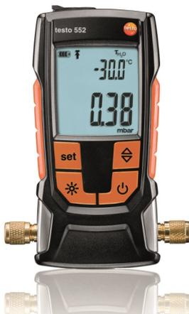
testo 552 ist ein digitales Vakuum-Messgerät zur Evakuierung von Kälteanlagen und Wärmepumpen. Es misst auch kleinste Absolutdrücke und liefert hochpräzise Informationen über den Status der Entfeuchtung einer Anlage (Entfernen von Fremdstoffen, u.a. Öle oder Fremdgase).
