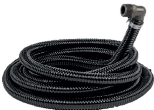
Dieser Abgasschlauch hilft Kältemittelsysteme der Klasse A3 nach der Rückgewinnung sicher zu vakuumieren. Er leitet die entzündlichen Ausgasungen von externen Zündquellen in der Nähe des Systems, welches vakuumiert wird, ab. Die Anschlüsse sind vernickelt.
