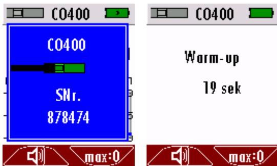
⇒ Nach dem Warm-up wechselt das Messgerät automatisch in den Messmodus.
